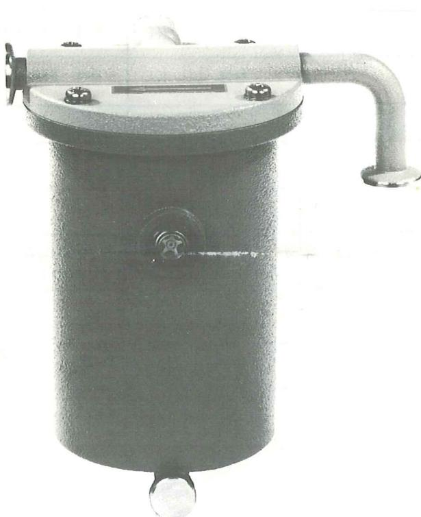
Bei verstopfter Filterpatrone öffnet sich das eingebaute Sicherheitsventil und verhindert zum Schutz von Filter und Pumpe einen unzulässig hohen Betriebsdruck. Das verstopfte Filterelement kann durch geeignete Lösungsmittel gereinigt werden.
